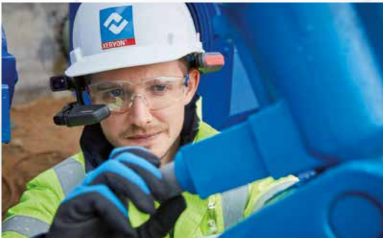
Za pomocą okularów cyfrowych obraz i dźwięk jest bezpośrednio transmitowany z miejsca wykonywania prac
